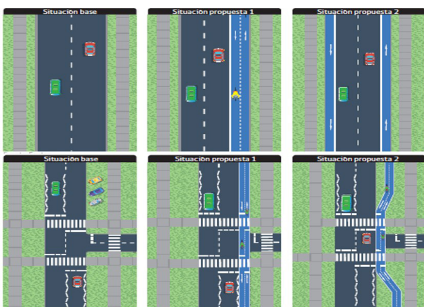
Fig. 15 Dos diferentes tipos de ciclovías de acuerdo con la Guía de composición y diseño operacional. Fuente: Sectra-MTT/CHILE 2019. (106)
